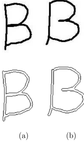
Şekil 6.20: Bir karaktere ait farklı sınır kümeleri (a) Üç sınır kümesine sahip olan B karakteri (b) İki sınır kümesine sahip olan B karakteri
