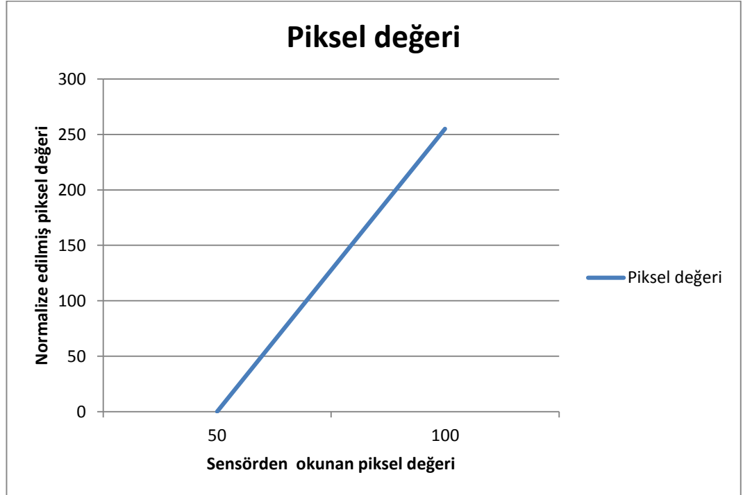
Şekil 6-5 Piksel normalizasyonu için hesaplanan y_i doğrusu
