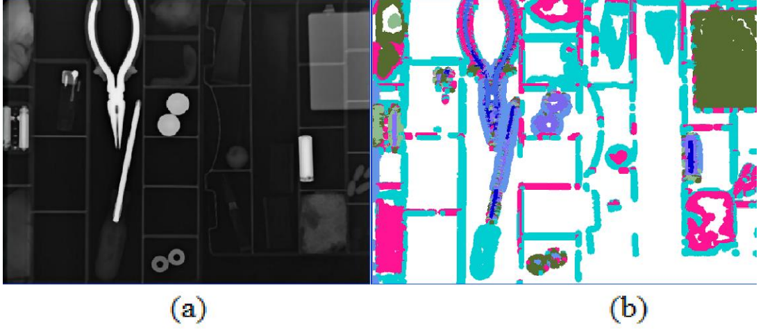
Şekil 3-3 (a) Şekil 3-2'de gösterilen test paketinin x-ışını görüntüsü, (b) x-ışını görüntüsü üzerinde renk bölütlemesi kullanılmasıyla elde edilen deneme analizi.
