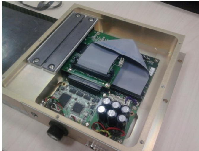
Şekil 4-4 Kullanılan Linx x-ışını sensör kutusunun iç görünüşü
