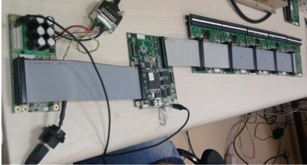
Şekil 4-6 X-ışını sensör dizilerinin seri olarak bağlanması
