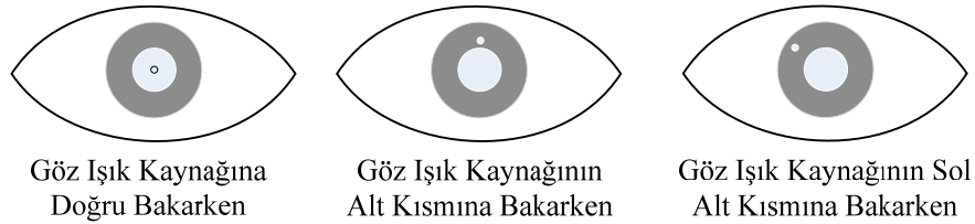
Şekil 3.2: Işık kaynağının korneada oluşturduğu parıltı örnekleri.
