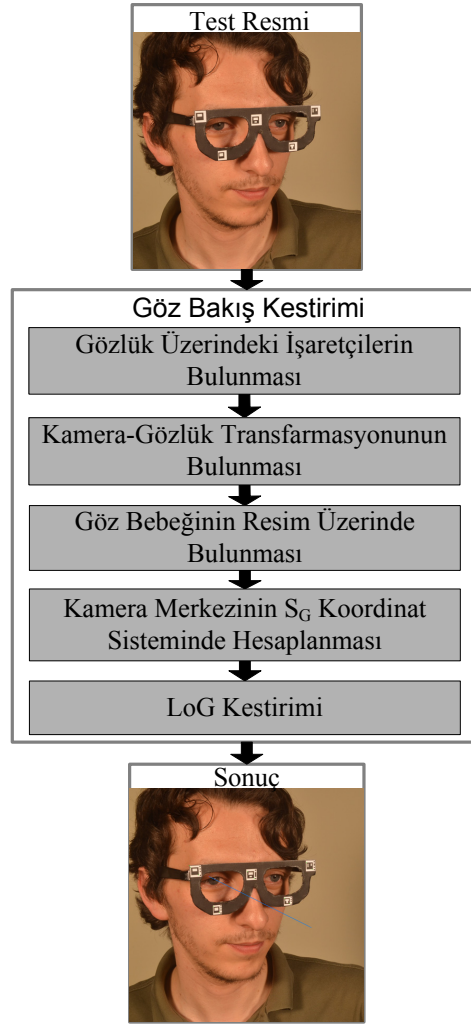
Şekil 10.1: Sistemin göz bakışı doğrultusunun kestiriminde izlediği adımlar.
