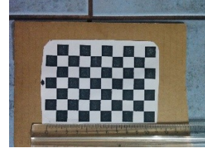
Şekil 2. Kamera kalibrasyon tahtası
